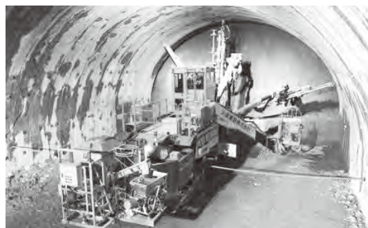
6m継ぎボルト打設装置を搭載した ロックボルト専用機「BOLTINGER」
