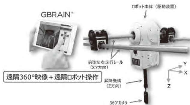
水門点検カメラロボット（GBRAIN）
