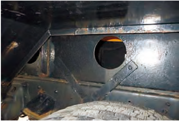
写真-5 試行塗料B シャシフレーム外側 (7年経過)
