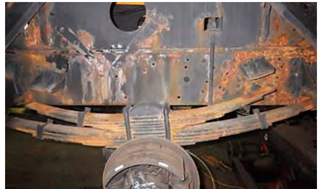
写真-8 途中から試行塗装Aを施工した車両状況2
