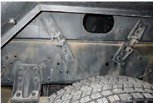
写真-3 試行塗装A シャシフレーム外側（8年経過）
