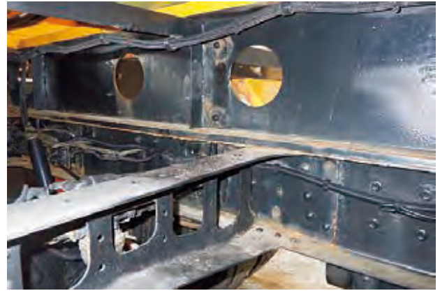
写真-6 試行塗料B シャシフレーム内側 (7年経過)
