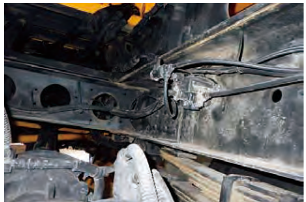
写真-4 試行塗装A シャシフレーム内側（8年経過）
