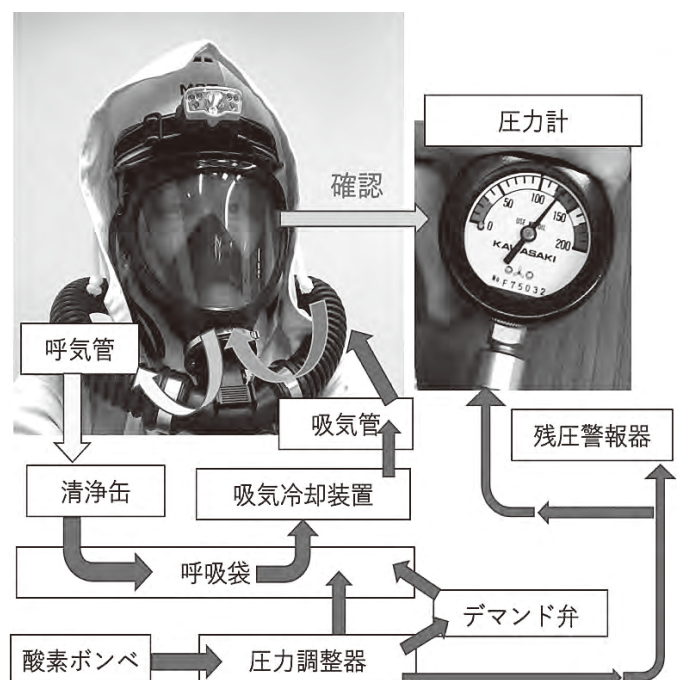
図1 酸素呼吸器概要図
