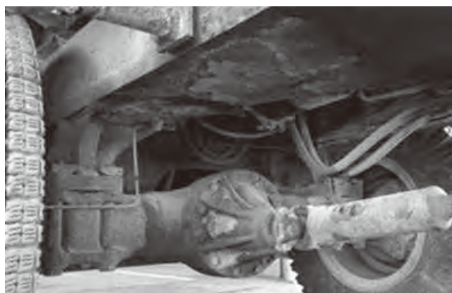
写真3 車体の著しい腐食状況
