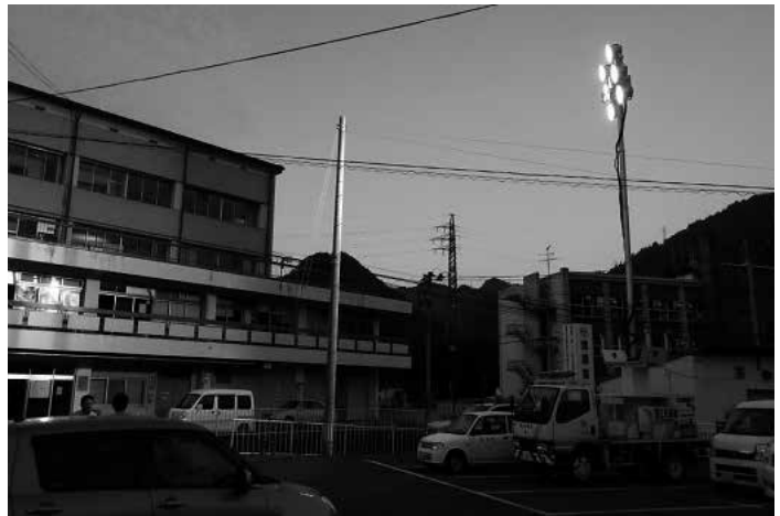
停電中の岩泉町役場を照らす照明車
