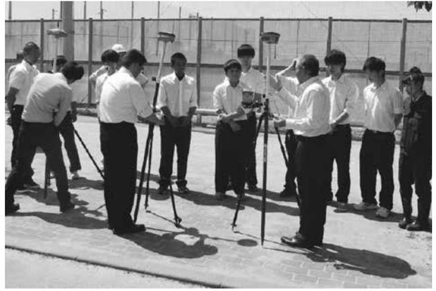
衛星測位による位置情報測量
