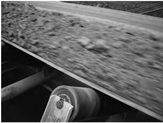
写真-2 ベルトコンベヤ上の土砂運搬状況
