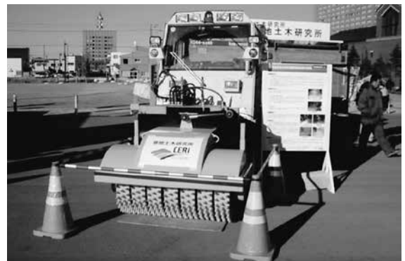
氷板・圧雪路面処理装置
