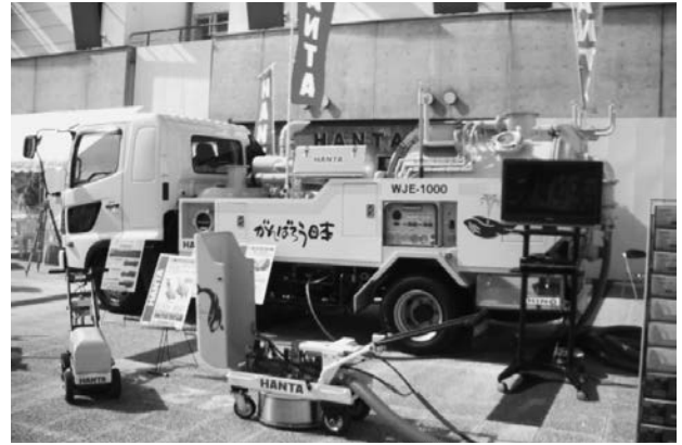
(屋外展示) 範多機械(株) 万能表面処理車 ウォータージェット工法で白線除去や路面洗浄・吸引回収します
