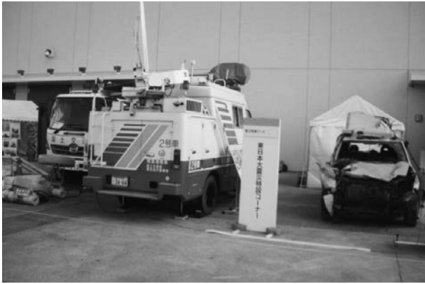
東日本大震災特設コーナー（屋外） （右）津波被害を受けた連絡車（中央、左）震災時に活躍した衛星通信車と排水ポンプ車
