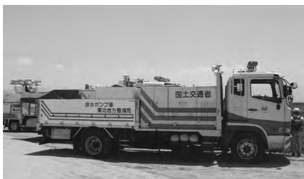
排水ポンプ車による内水排除訓練
