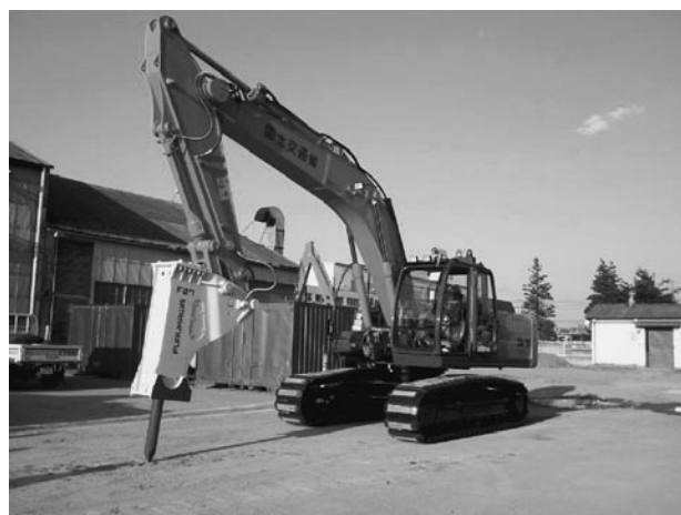
写真－７ 油圧ブレーカー
