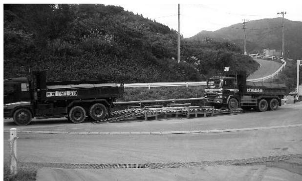
写真－7 乾式泥落とし装置使用状況
