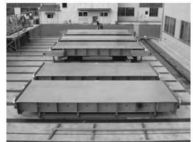
写真-6 2号ゲート金属水密部
