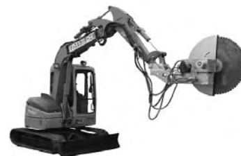
写真1 マッスルカッターII型 国土交通省新技術情報提供システム NETIS登録No.TH-020055-A
