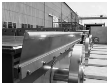
写真-5 1号ゲート金属水密部
