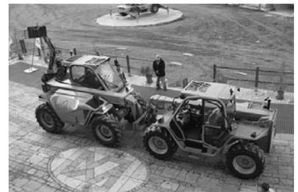
写真3-5 Merlo社のももセンター。Hydraulic Transmissionを搭載した機械と搭載していない機械の押し合いの様子。
