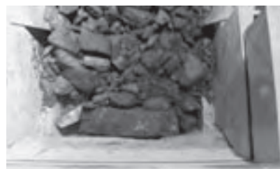
発破ズリクラッシャー投入状況 (歯幅を200mm以下になるよう調整)
