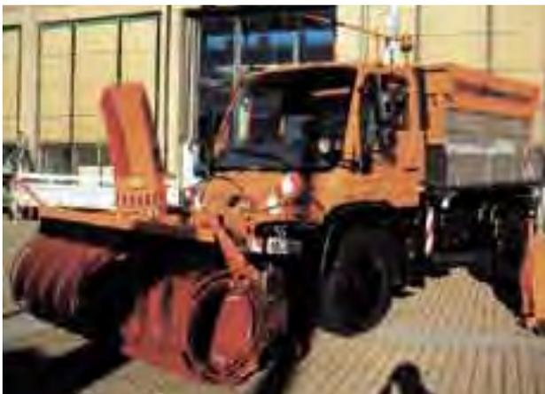
トラックにロータリーをアタッチメントとして設置した除雪機
