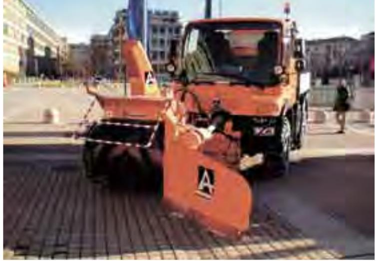
ロータリーとブレードの両方を備えた除雪機。これも専用機と言うよりもむしろトラックにアタッチメントを付けた構造になっている。
